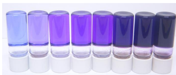
図 3. γ線により発色するゲル材料
